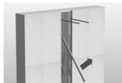
При помощи трубы отогнуть стержни.
